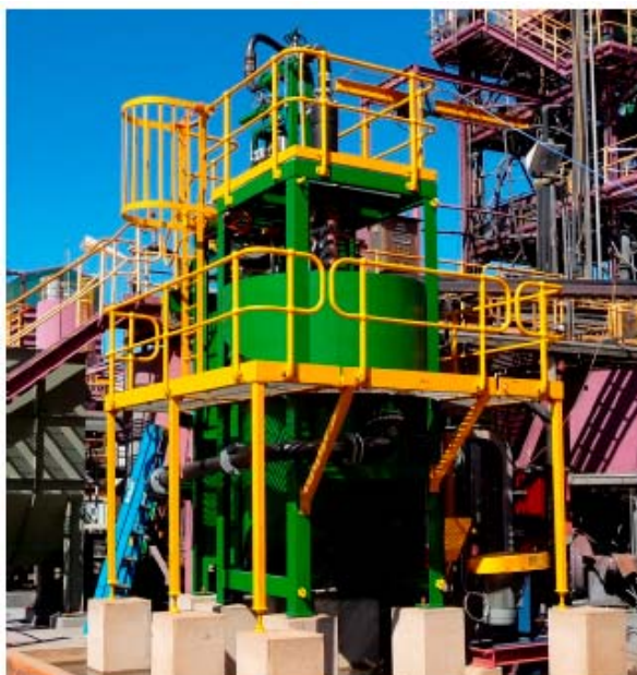
Рисунок 16. Флотомашина Джеймсон Z1600 на обогатительной фабрике Cosmos
