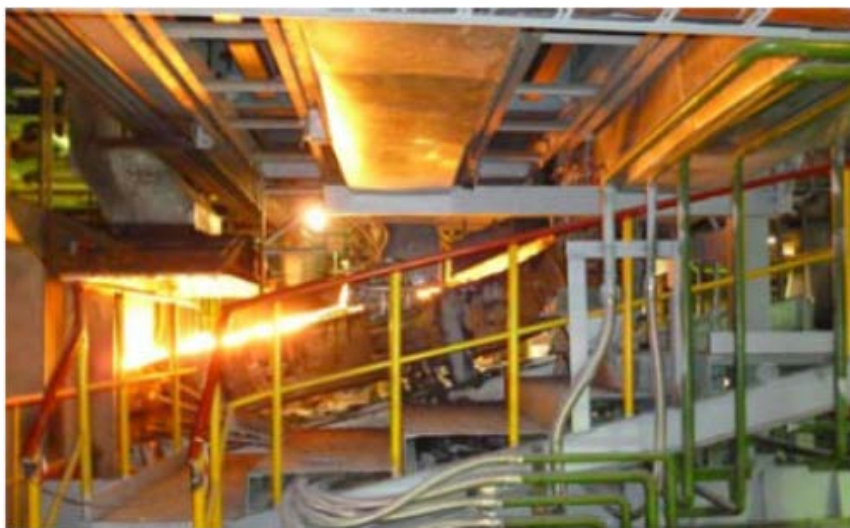
Рисунок 4 – Выпуск штейна из медной печи ISASMELT на Казцинке
