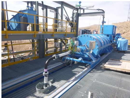
Рисунок 2 - Цикл измельчения IsaMill - Проект GPM Gold
