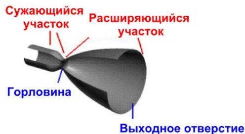
Рисунок 3 Разрез суживающегося сопла с расширением (NASA, 2015 г.)
