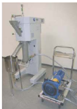
Модель: башенная мельница NE008 Емкость: 8 л Проба: ~ 10 кг / тест Длительность тестирования: 1 неделя Цель: предварительная проверка измельчаемости
