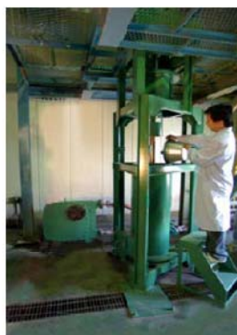
Модель: башенная мельница KM-5 Емкость: 120 л Проба: примерно 150 кг / тест Длительность тестирования: 2 недели Цель: расчет размера мельницы для технологической гарантии
