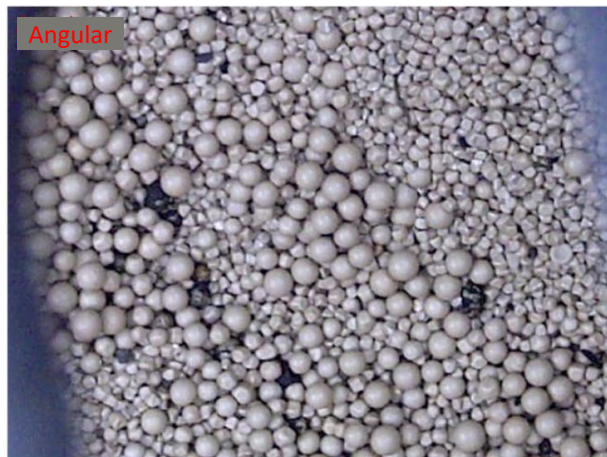
Figura 8: Desgaste no uniforme de los medios de molienda Angular (izquierda), Plano (derecha) (Glencore Technology, 2018a)
