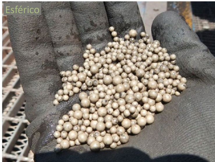
Figura 7: Desgaste uniforme de los medios de molienda (Glencore Technology, 2018a)
