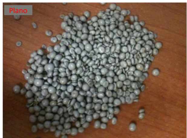
Figura 8: Desgaste no uniforme de los medios de molienda Angular (izquierda), Plano (derecha) (Glencore Technology, 2018a)
