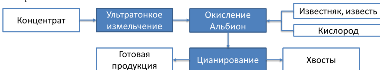
Рисунок 2 – Схема переработки упорных сульфидных золотосодержащих концентратов по технологии «Альбион»
