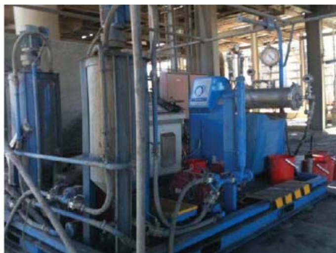
Рис. 10. Для проектирования и масштабирования цикла доизмельчения меди и пирита была использована пилотная установка IsaMill M20
