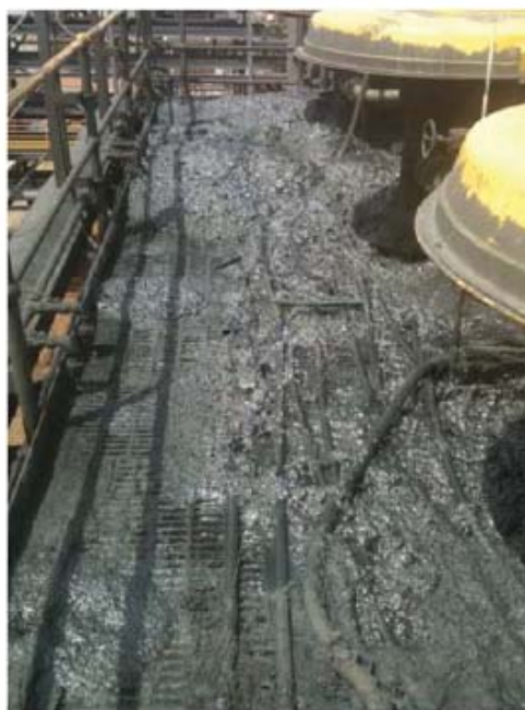
Рис. 6. Фотография перегруженных машин вторичной перечистой флотации технологической линии 2 до установки флотомашин Джеймсон
