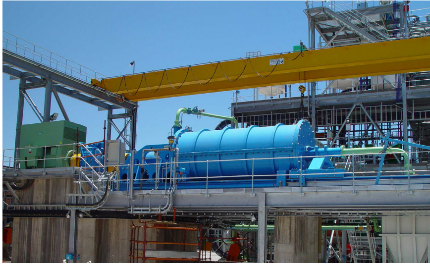
图四 在南非铂族金属矿山使用的大型艾萨磨机，单机功率2600千瓦
