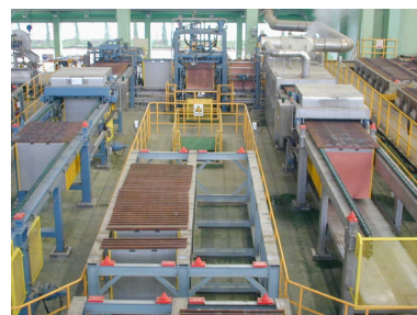
图七 贵溪铜精炼厂和艾萨电解法剥离机组
