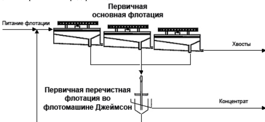
Рисунок 6. Технологическая схема цикла основной перечистой флотации с использованием флотомашин Джеймсон
